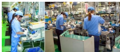
□セル方式による生産ライン
